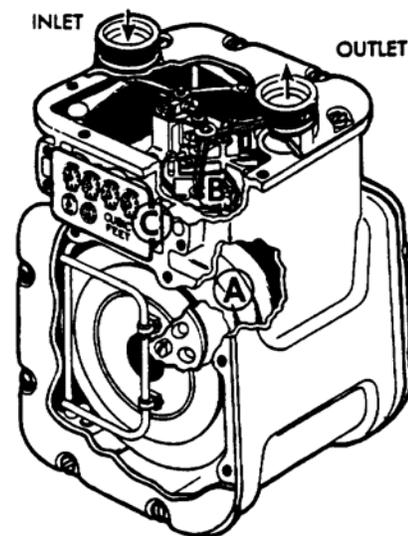
Figure 1. Diaphragm Meter
