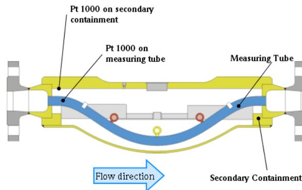
Figure 1. Coriolis Meter
