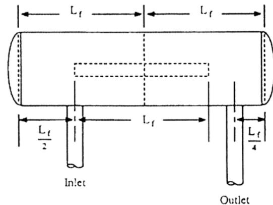
FIGURE 2. SINGLE BOTTLE LOW-PASS ACOUSTIC FILTER
